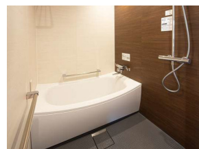
トイレやバスルーム、 階段に手すりを設置 段差を解消して バリアフリーに
